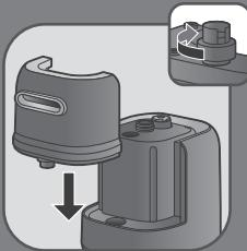
**BG** Завийте докрай капачката на резервоара за вода и поставете резервоара обратно на мястото му.
