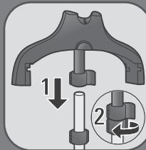
**RU** Полностью вставьте вешалку вертикально в верхнюю часть стойки и зафиксируйте.
