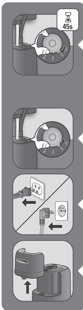
**BS** Za uključivanje aparata okrenite tipku za uključivanje/isključivanje (On/Off). Zatim okretanjem tipke podesite količinu pare.
