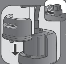
**RU** Полностью закрутите крышку резервуара для воды и установите резервуар обратно в устройство.
