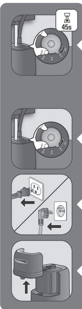
**RU** Поверните переключатель, чтобы включить устройство. Затем выберите с помощью переключателя мощность паровой струи.
