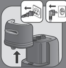
**EE** Eemaldage seade toiteallikast ja seejärel eemaldage veepaak.
