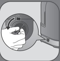
**BS** Namjestite aparat iznad sudopera i odvrnite «Anti calc» čep okretanjem u smjeru suprotnom smjeru kretanja kazaljki na satu.
