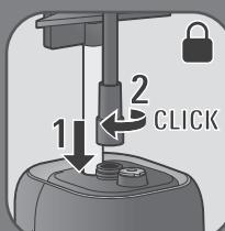
**RU** Вставьте паровой шланг и зафиксируйте его, закрутив до щелчка.
