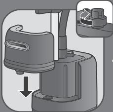
**EL** Βιδώστε μέχρι τέλους το πώμα της δεξιάμενής νερού και ξαναποθετήστε τη δεξιάμενή στη συσκευή.
