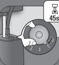
**RU** Поверните переключатель, чтобы включить устройство. Затем выберите с помощью переключателя мощность паровой струи.
