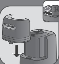
**RU** Закрутите крышку и установите резервуар обратно в устройство.
