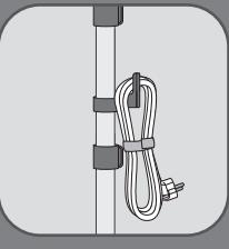
**EL** Τυλίξτε το ηλεκτρικό καλώδιο και τοποθετήστε το στο άγκιστρο.
