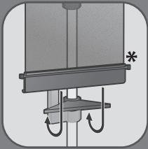
**RU** Вытяните опору и зафиксируйте ее нижний край, отрегулировав натяжение с помощью специального крюка.
